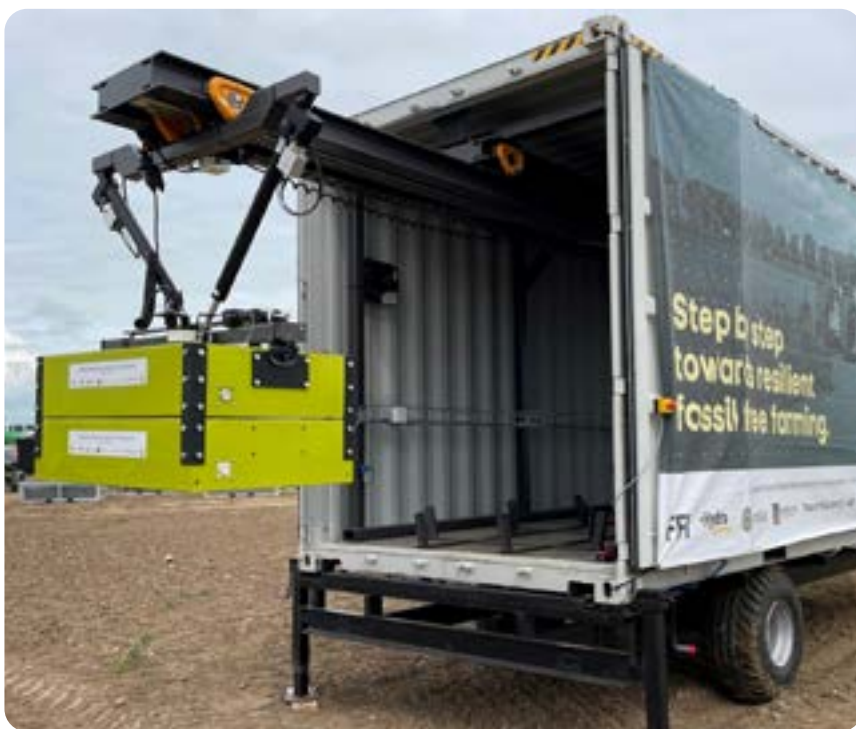
▲ Batteribytesstationen är byggd i en 20-fotscontainer och kan automatiskt ladda och byta batterier på jordbruksmaskinen i projektet. Foto: Jonas Engström
